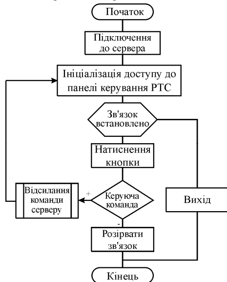
Рис 5. Блок-схема роботи клієнтської частини ПЗ
