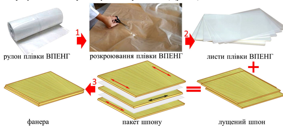
Рис. 1. Схема виготовлення фанери / The scheme of plywood production
