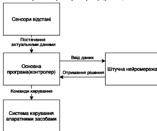
Рис. 1. Загальна структура макету системи керування автономним роботом / General structure of the mock-up control system for an autonomous robot
