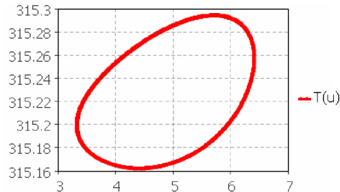
Рис. 4. Фазова діаграма залежності коливань температури T(u) біля середньої температури від коливань напруженні у стаціонарному стані, аттрактора
