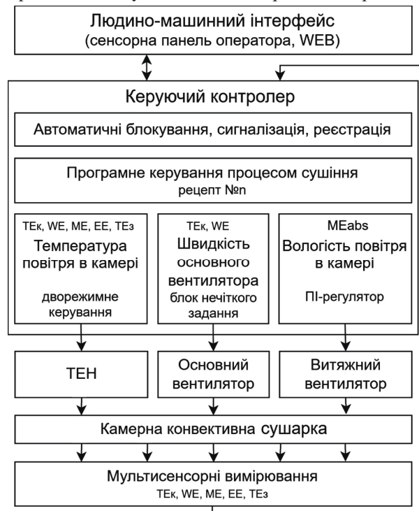
Рис. 3. Структурна схема комплексної системи автоматизації конвективної камерної сушарки / Structural diagram of the comprehensive automation system of a chamber convective dryer
