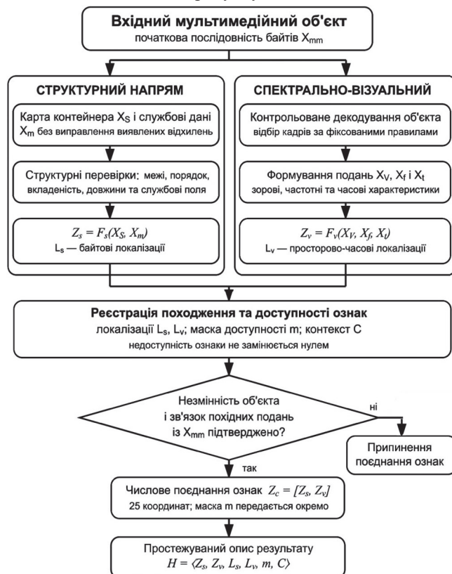
Рисунк. Послідовність етапів формування структурного та спектрально-візуального подань зі збереженням походження ознак / The sequence of stages in the formation of structural and spectral-visual representations whilst preserving the origin of features
