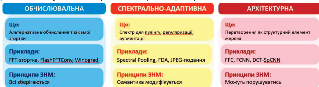
Рисунок. Запропоновані парадигми використання перетворень у ЗНМ / Proposed paradigms for using transforms in CNNs
