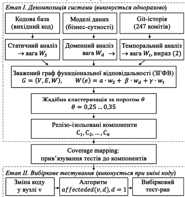
Рис. 1. Загальна схема методу граф-орієнтованої декомпозиції монолітних систем / General scheme of the graph-based decomposition method: Етап I – одноразова побудова ЗГФВ і виділення компонентів / Stage I – one-time construction of the WFRG and component extraction; Етап II – вибіркове тестування програмного забезпечення в разі кожної зміни коду / Stage II – selective testing at each code change
