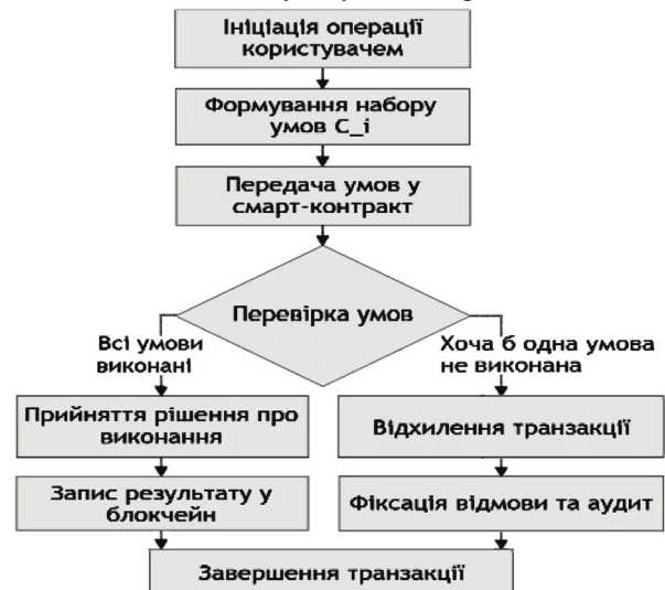
Рис. 3. Процес проходження транзакції в інформаційній системі обліку торгівлі зброєю з використанням смарт-контрактів / The process of transaction execution in the information system for recording weapons trade using smart contracts
