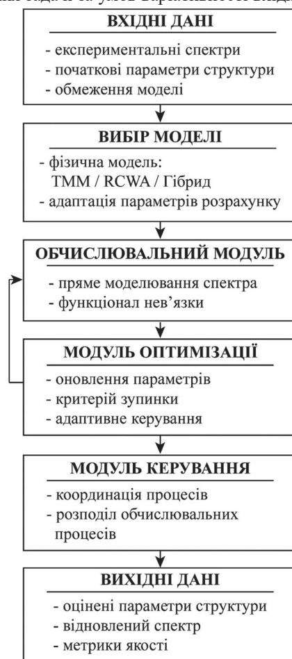
Рис. 4. Схема обчислювальних процесів розробленої інформаційної технології / Scheme of computational processes of the developed information technology
