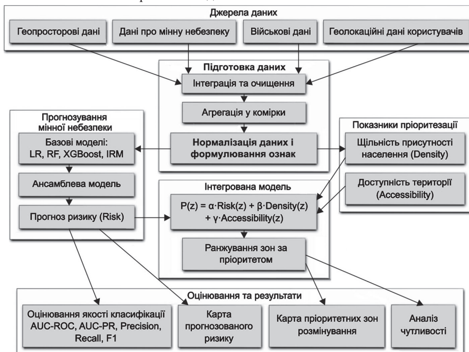
Рис. 1. Схема методу визначення пріоритетності гуманітарного розмінування територій / Diagram of the proposed method for prioritizing humanitarian demining
