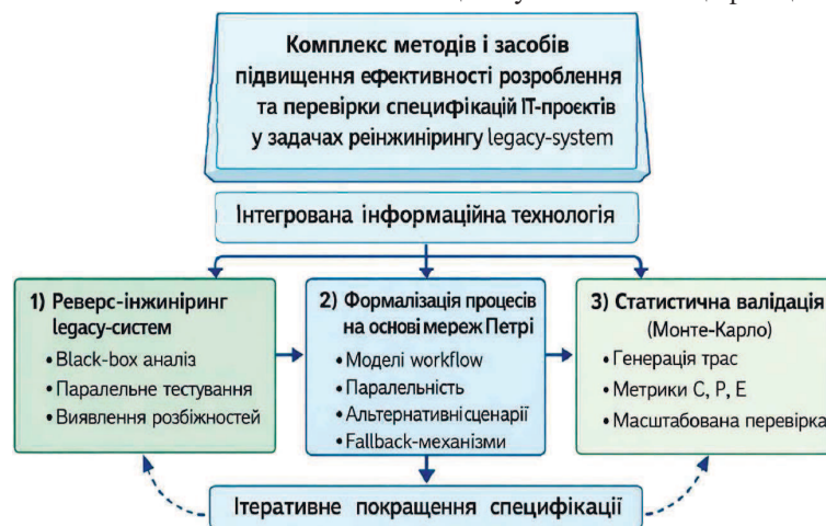
Рис. 1. Підсистеми інформаційної технології синтезу та валідації специфікацій вимог до ІТ-проектів під час реінжинірингу legacy-систем / Subsystems of the information technology for developing and validating specifications in IT project re-engineering of legacy systems
