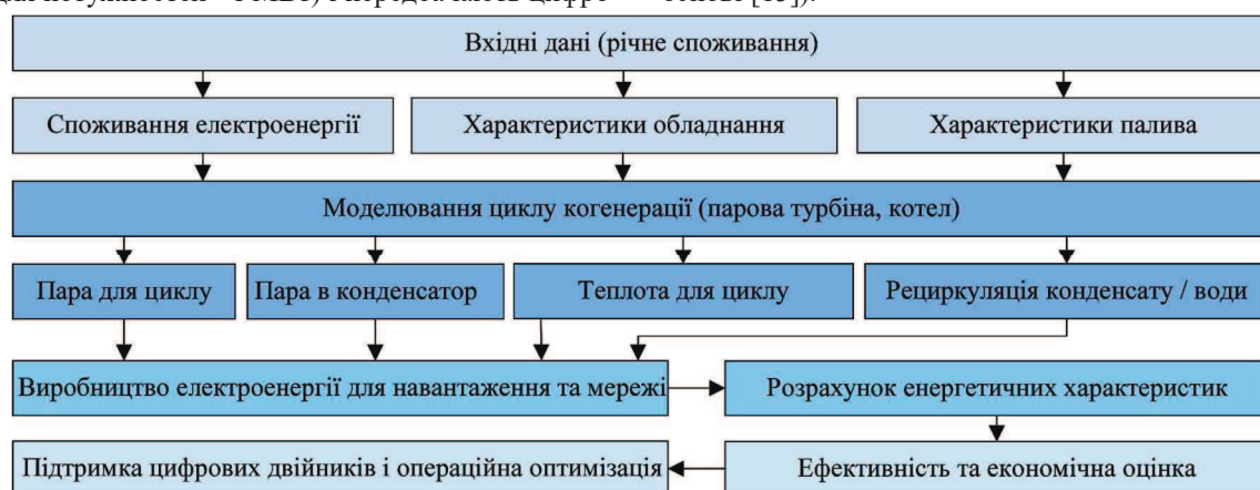
Рис. 2. Схема складання енергетичних характеристик біомасової когенераційної електростанції для одночасного виробництва електроенергії та технологічного тепла / Scheme for compiling energy characteristics of biomass cogeneration power plants for simultaneous production of electricity and process heat [15]
