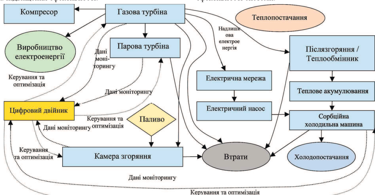
Рис. 4. Схема інтегрованої ГТУ з цифровим двійником для моніторингу та оптимізації режиму роботи / Integrated GTU diagram with digital twin for monitoring and optimisation of operating modes [4]
