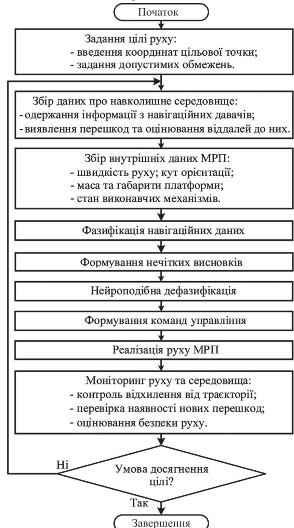
Рис. 9. Граф-схема алгоритму нейронечіткого управління рухом МРП / Graph diagram of the algorithm for neurofuzzy motion control of the MRP
