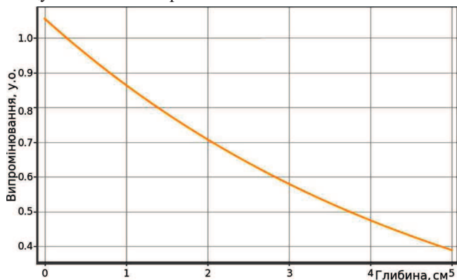
Рис. 3. Залежність інтенсивності випромінювання від глибини вимірювання з урахуванням затухання хвиль / Dependence of radiation intensity on the measurement depth with wave attenuation
