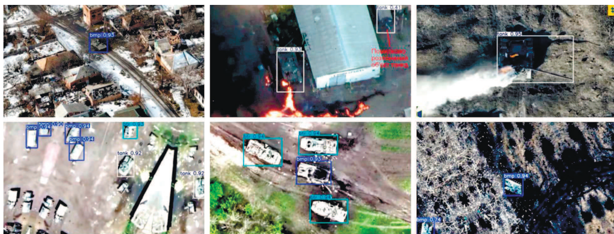
Рис. 11. Результат тестування навченої моделі YOLOv8n / Trained YOLOv8n model testing output
