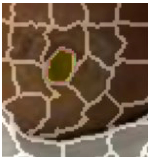
Fig. 8. Example of an ideal SLIC algorithm segmentation / Приклад досконалої сегментації алгоритмом SLIC
