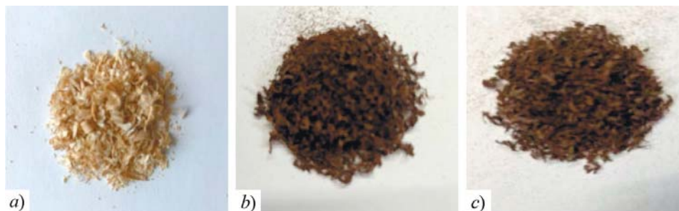
Рис. 1. Дрібнодисперсні зразки / Finely dispersed samples: a) деревина ясеня / ash wood (W-Ash); b) термічно модифікована деревина ясеня (ТМДЯ) / thermally modified ash wood (TM-Ash); c) термічно модифікована деревина ясеня, експонована у природному середовищі (ТМДЯ експ ) / thermally modified ash wood exposed in the natural environment (TM-Ash exp )
