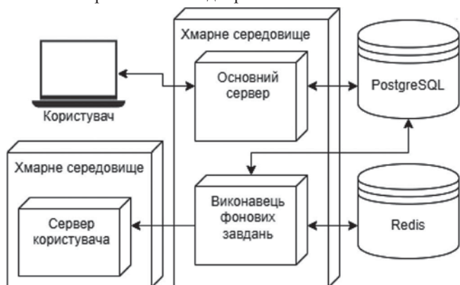
Рис. 1. Архітектура розподіленого застосунку Harvester / Architecture of Harvester distributed application
