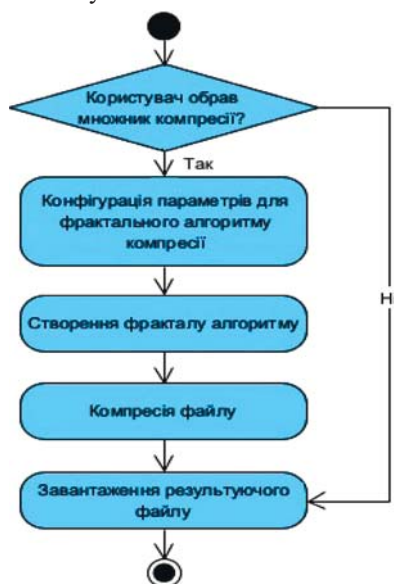
Рис. 5. UML-діаграма діяльності підпроцесу "Фрактальна компресія файлу" / UML activity diagram of the Fractal File Compression subprocess
