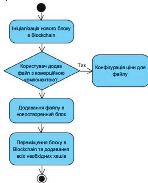
Рис. 6. UML діаграма діяльності підпроцесу "Додавання файлу в торговельну систему" / UML activity diagram of the subprocess "Adding a file to the trading system"
