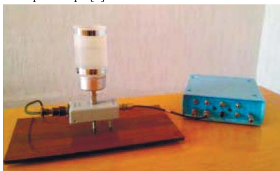
Рис. 6. Вигляд одноканального акустотермометра / View of a single channel acoustic thermometer
