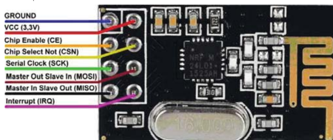
Рис. 4. Радіомодуль nRF24L01 / Radio module nRF24L01
