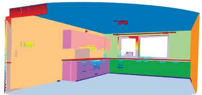
Рис. 3. Хмара точок після об'єднання кластеризованих двох підплощин / Point cloud after merging the clustered two subplanes
