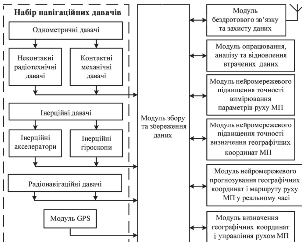
Рис. 1. Структура системи інтелектуального визначення координат МП за умови дії завад / Structure of the system of intelligent determination of the coordinates of the MP in the conditions of interference
