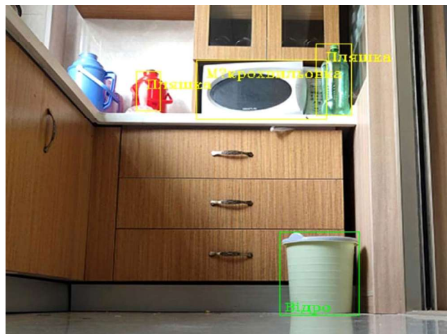
Рис. 3. Розпізнавання предметів на кухні. Зелений колір – правильно знайдений предмет, жовтий колір – додаткові знахідки розробленого алгоритму, не анотовані в наборі даних / Objects recognition in the kitchen. Green colour – item detected correctly, yellow colour – extra findings of developed algorithm not annotated in dataset
