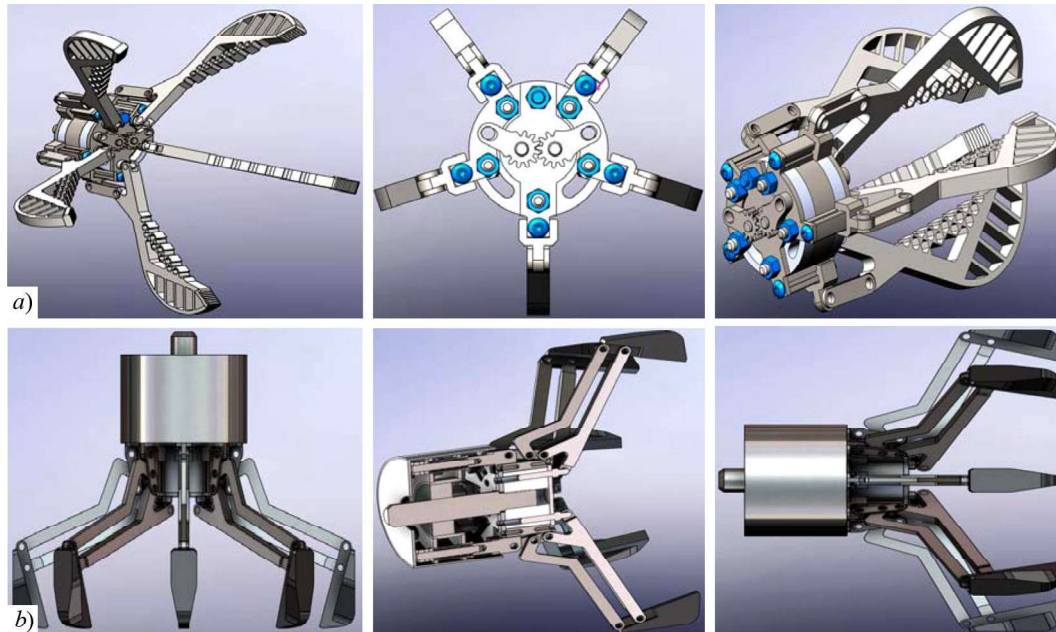
Рис. 4. Результати моделювання кінцевого ефектора маніпулятора БРП / Results of simulation of the end effector of MRP manipulator
