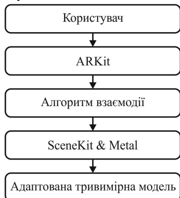
Рис. 3. Структура розробленої системи / Structure of the developed system
