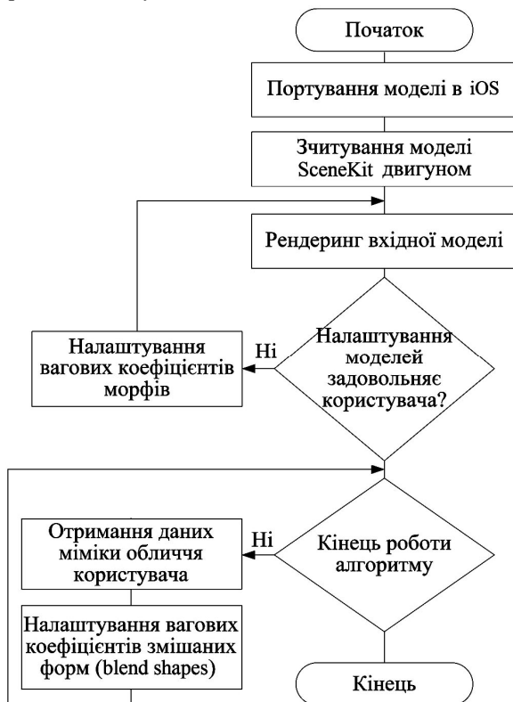
Рис. 2. Алгоритм роботи системи синтезу тривимірної аватару користувача на платформі iOS / Algorithm of the system for synthesizing a three-dimensional user avatar on the iOS platform
