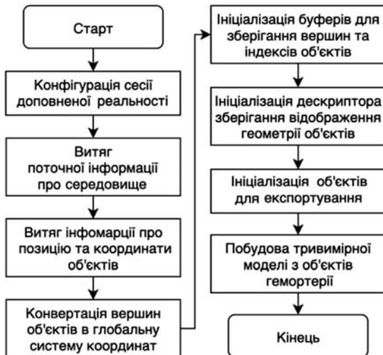
Рис. 1. Блок-схема алгоритму роботи системи для побудови моделі навколишнього середовища / Block diagram of a system algorithm for building an environmental model
