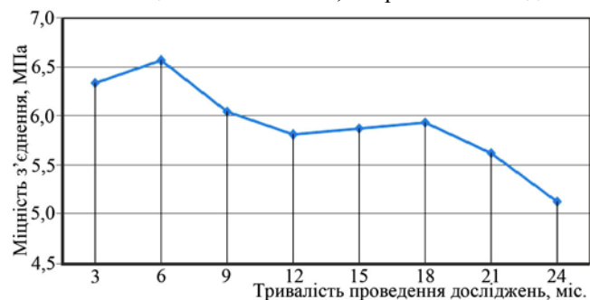
Рис. 6. Міцність термічно модифікованої деревини ясеня і немодифікованої деревини сосни за тривалим методом / Strength of thermally modified ash wood and unmodified pine wood determined by the long-term method
