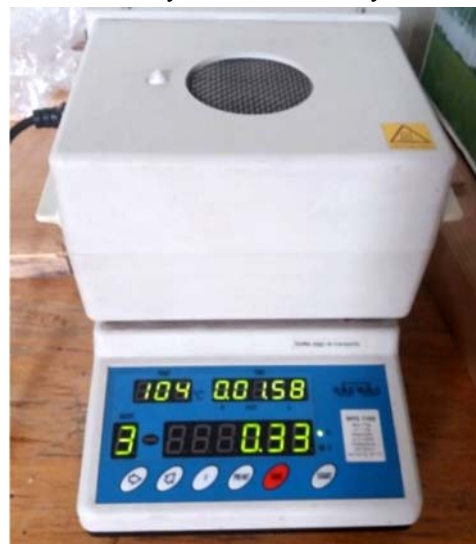
Рис. 1. Лабораторний аналізатор вологи RAD WAG WPS 110 S / The RAD WAG WPS 110 S laboratory moisture analyzer
