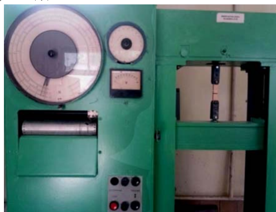
Рис. 4. Розривна машина Р-05 для випробування зразків на розтяг уздовж волокон / The R-05 tensile-testing machine for testing specimens in tension parallel to grain
