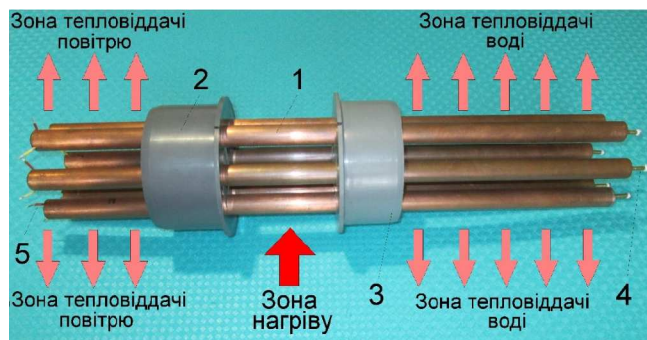
Рис. 2. Експериментальна модель теплообмінника: 1) теплові трубки; 2, 3) фланці; 4) клапани; 5) нагрівальні елементи
