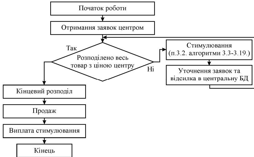
Рис. 5. Спрощений алгоритм функціонування програмного модуля "Inventory Controls"
