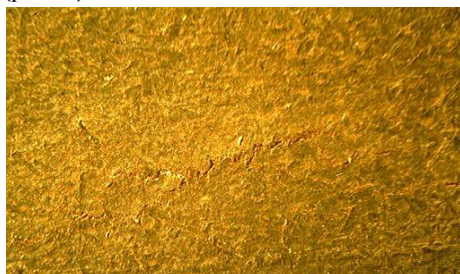
Рис. 1. Микротрещина в пласти пластика после выгрузки из пресса
