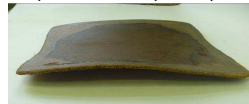
Рис. 3. Покоробленный образец пластика с трещиной после нормализации
