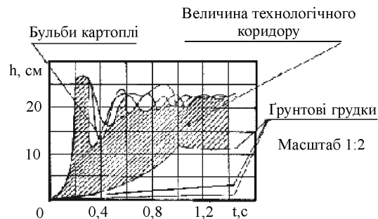
Рис. 3. Криві спливання бульб картоплі і ґрунтових грудок різних розмірів з БПШ, суміщені за "стартовим моментом"
