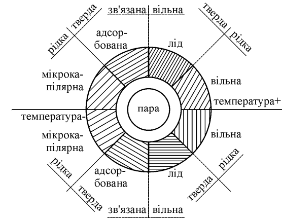
Рис. 5. Кругова діаграма стану води у зразку з нерівномірною температурою
