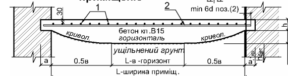
Рис. 5. Елементи пропонованої плити підсилення із криволінійною підшовою
