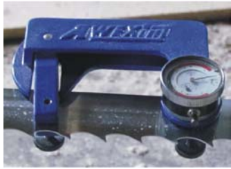
Рис. 4. Тензометр для контролювання напруження попереднього натягу в полотні стрічкової пилки
