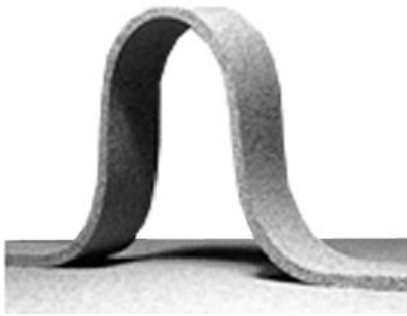
Рис. 2. Новий композиційний еластичний матеріал Resoflex
