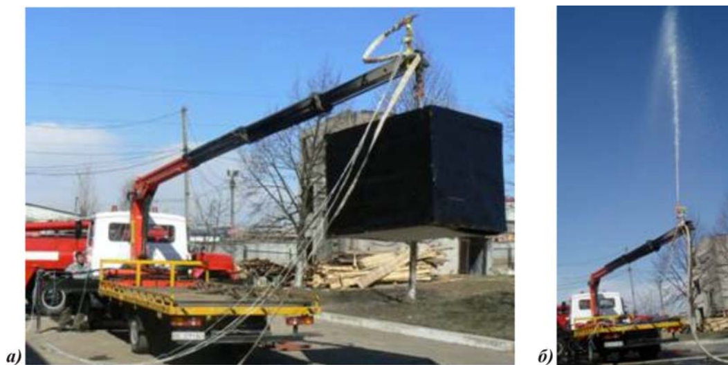
Рис. 6. Робота маніпулятора з контейнером (а) і заміри характеристик маніпулятора під час роботи зі стволом (б)
