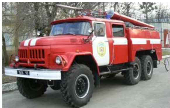
Рис. 1. Пожежна автоцистерна АЦ-40 на базі автомобіля ЗиЛ-131 з установленим комплектом апаратури для визначення спектру характеристик транспортних засобів
