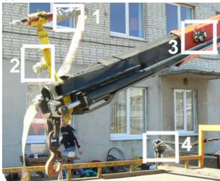
Рис. 5. Розміщення давачів тиску (1) та вібрацій на кронштейні ствола (2), видовження (3) на базовій секції маніпулятора і давача вібрацій на кузові (4) автомобіля
