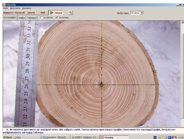
Рис. 5. Визначення щорічного приросту за поперечними зрізами програмою "Таксатор"
