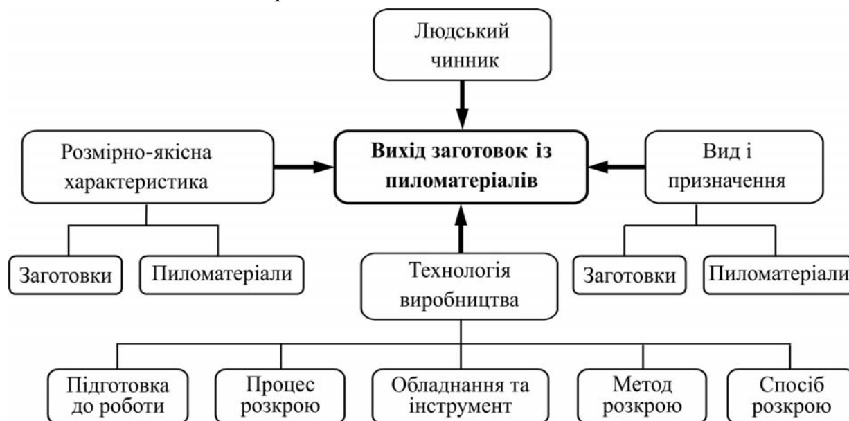
Рис. 2. Узагальнена схема впливу основних факторів на вихід заготовок із пиломатеріалів
