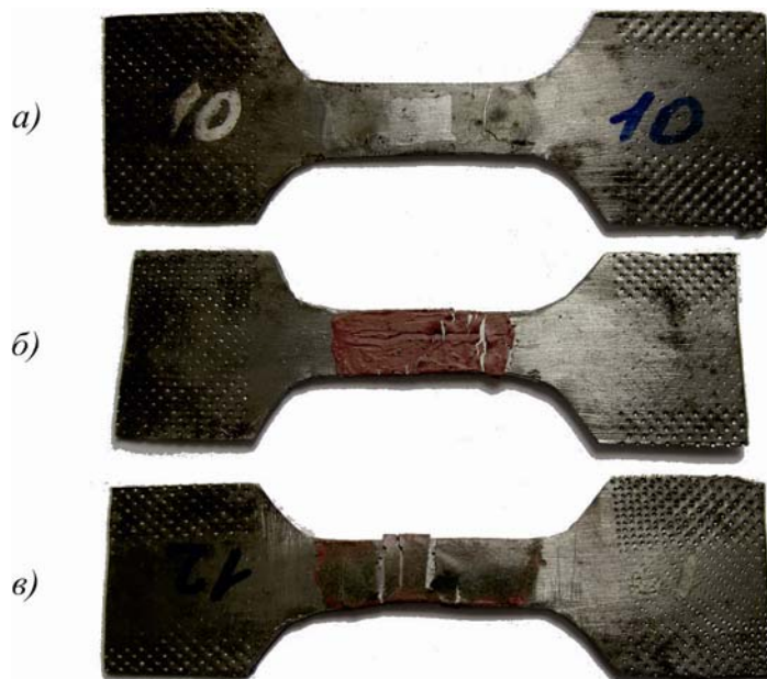
Рис. 3. Зовнішній вигляд зразків після дослідження на розтяг: а) № 2; б) № 4; в) № 6 (позначення див. у табл. 1)
