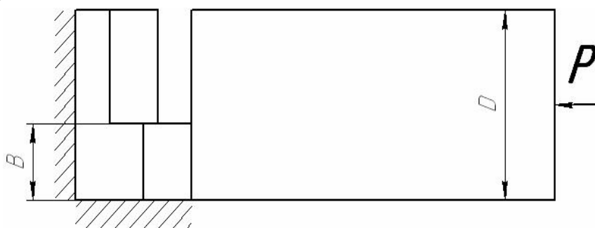
Рис. 2. Початковий момент розколювання кряжа робочим органом східчастої форми
