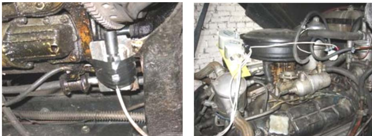
Рис. 5. Розміщення давача обертів маховика і плат витратоміра і тахометра у моторному відсіку автомобіля
