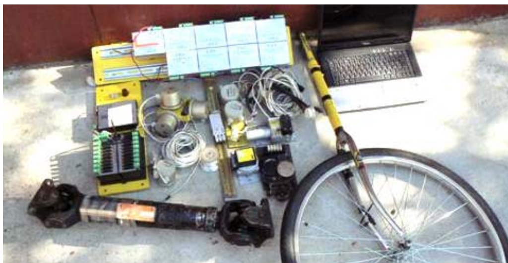
Рис. 3. Комплекс апаратури для визначення спектра характеристик транспортних засобів: 1 – інтегрований у вимірювальний комплекс автономний ПК з програмним забезпеченням на базі ноутбука; 2 – модуль ЦАП-ЦАП з гальванічною розв'язкою, лініями цифрового вводу-виводу; 3 – модем для дистанційної передачі даних; 4 – карданний вал з тензомостом та інформаційним передавальним модулем; 5 – тахометр з давачем обертів маховика; 6 – плата переміщення і швидкості руху; 7 – витратомір палива; 8 – вібродавачі; 9 – Давач лінійних переміщень; 10 – "п'яте" колесо з геконовим давачем обертів; 11 – блоки живлення давачів; 12 – акселерометр, 13 – давач повороту керма
