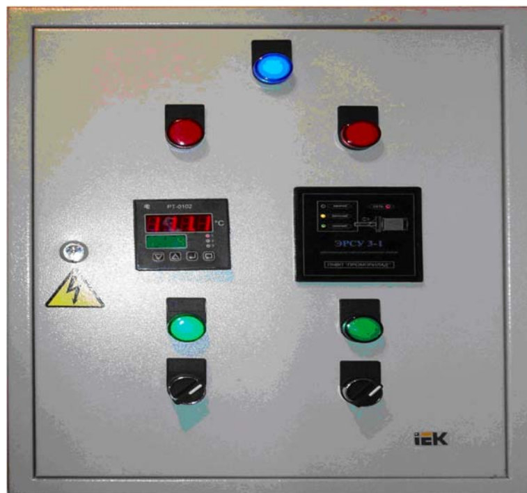
Рис. 2. Пульт керування лабораторною установкою для пропарювання деревини
