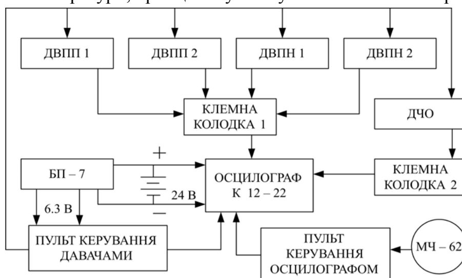
Рис. 1. Блок-схема вимірювальної апаратури для здійснення експериментальних досліджень вертикальних коливань автовоза: ДЧО – давач числа обертів "п'ятого" колеса; ДВПП1, ДВПП2 і ДВПН1, ДВПН2 – давачі вертикальних пришвидшень точок відповідно підресорних і непідресорених мас напівпричепа для передньої (1) і задньої (2) осей; МЧ-62 – годинник
