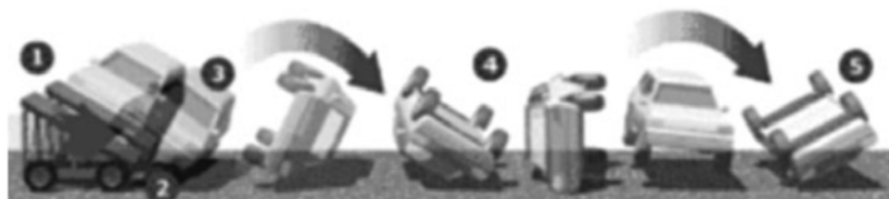
Рис. 10. Тотожність кінематики перекидання автомобілів автобусам [61]
