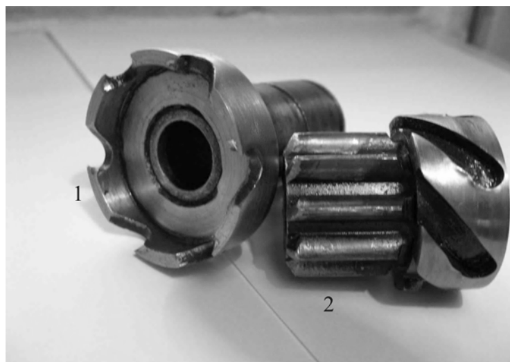
Рис. 3. Загальний вигляд ведучої 1 і веденої 2 напівмуфт після перевантажень
