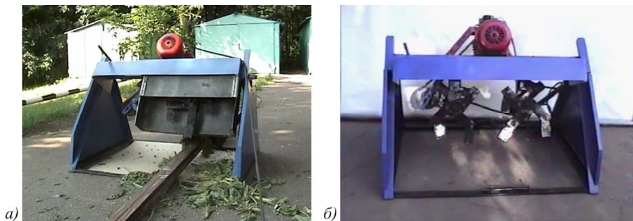
Рис. 1. Лабораторна установка для подрібнення рослин: а – з одним ротором; б – з двома роторами
