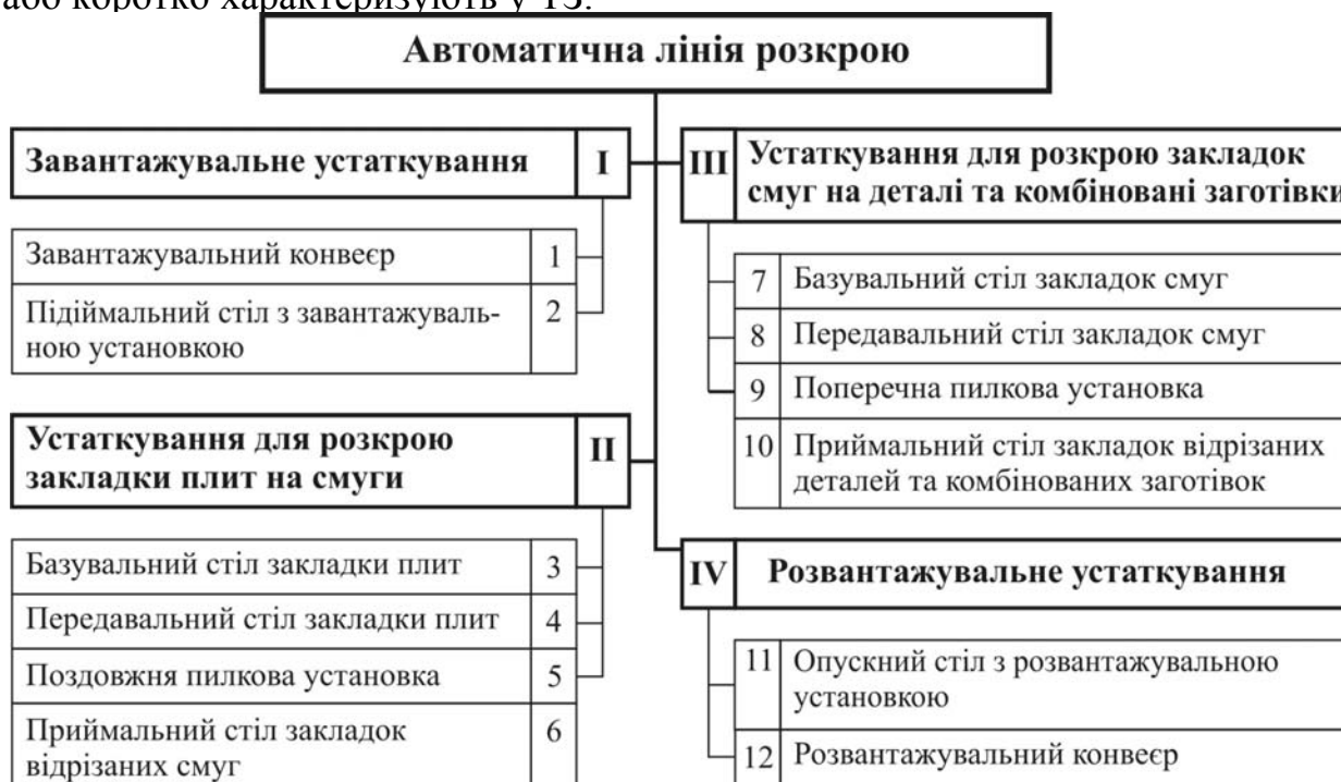
Рис. 2. Ієрархічна структура Г-подібної автоматичної лінії розкрою ПДМ на заготовки з притискними балками
