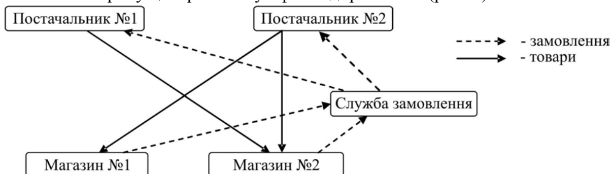
Рис. 2. Схема руху замовлення і товарів для централізованої системи замовлення без наявності центрального складу
